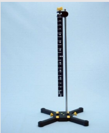
Configuración de prueba para la investigación del péndulo de reversión
