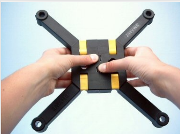
Desmontando la base del trípode
